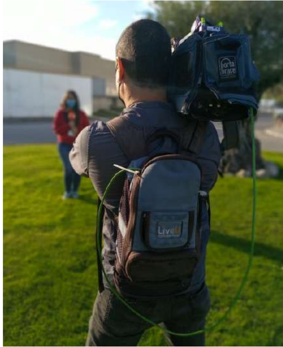
Figura 15. Operador de cámara con mochila LiveU para cobertura de directos. Fuente: Gonzalo Gómez/Suso Malla.
