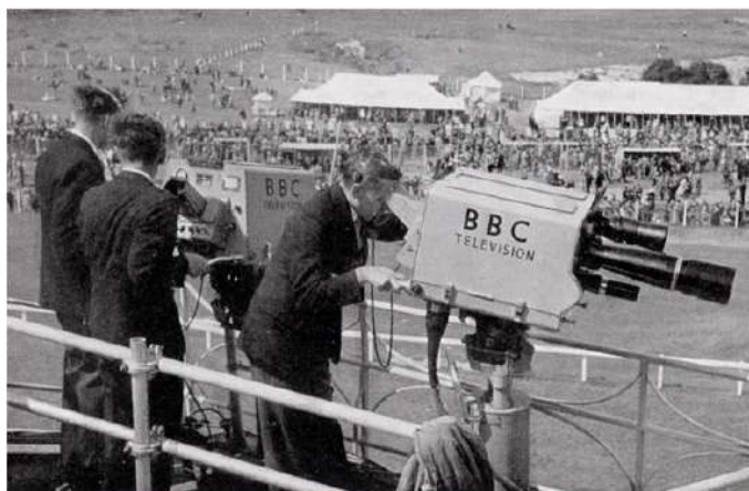
Figura 3. Cámaras Pye Mk1 en una transmisión exterior de la BBC desde el hipódromo de Ascot. Fotografía de la BBC. Fuente: (tvcameramuseum.org, s.f).
