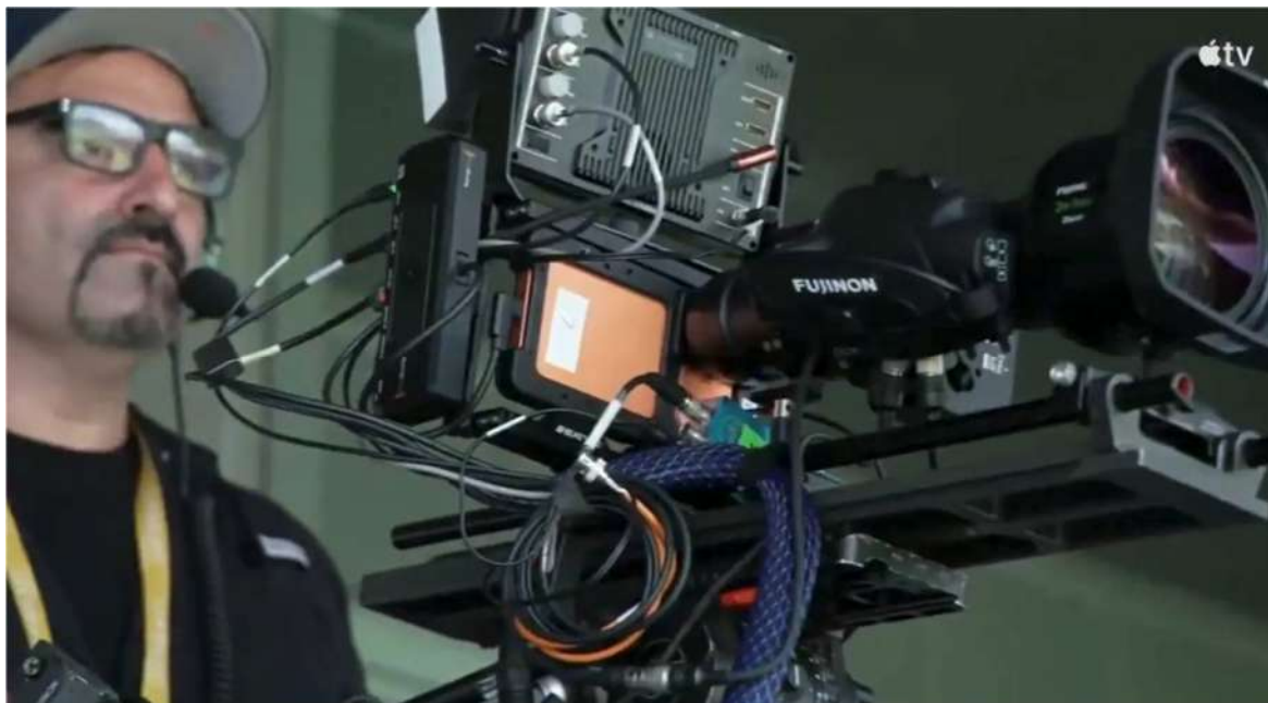
Figura 46. Adaptación de un teléfono inteligente (iPhone 17 Pro) a una cámara profesional para su uso en una retransmisión en directo. Fuente: (Castañón, 2026).
