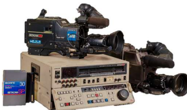
Figura 5. Conjunto de cámara, magnestocopio reproductor/grabador y cinta Betacam SP. Fuente: (RTVE, 2017)
