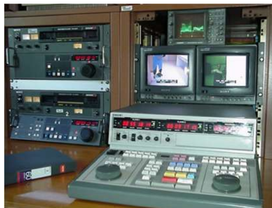
Figura 13. A) Edición al corte con 2 magnetoscopios Betacam. B) Edición A/B roll con sistema Sony BVE 600. Elaboración propia.
