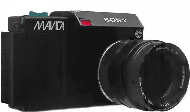
Figura 11 - Sony Mavica (1981). Câmara que capturava imagens de 0,3 megapixels e custava aproximadamente uns 12 mil dólares.
